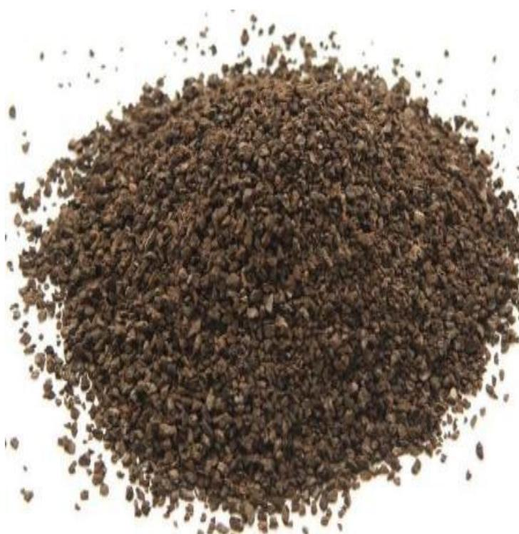
**les tensio-actifs que l'on retrouve dans les dégraissants et produits de nettoyage modifient les fibres des absorbants polypropylène hydrophobes et les rendent hydrophiles, phénomène inexistant sur le LISORB**
